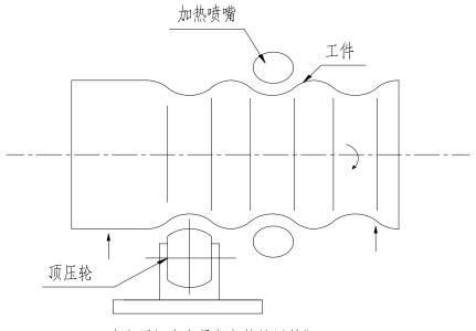
在专用机床上局部加热旋压炉胆
